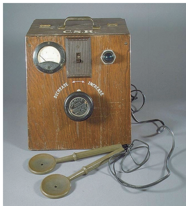
図1：クロード・ベックの除細動器。金属のパドルを直接心臓にあて、110Vの交流電源をトランスで昇圧、通電する。
