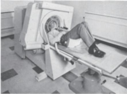
図 1 : ハウンズフィールドが開発した世界最初の CT 装置 (左) とコンピュータ操作コンソール<sup>2)</sup>。
