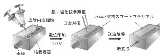
図4. 電気化学細胞脱離を用いた血管構造構築
